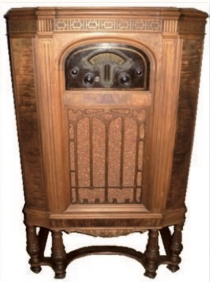
Atwater Kent 480 fabricado en 1932 dotado con dos bandas de onda media y tres de onda corta. Fue el primer modelo de Atwater Kent que tuvo cobertura total de la banda de onda corta. Contaba con 10 válvulas y se conectaba a la red de corriente alterna
